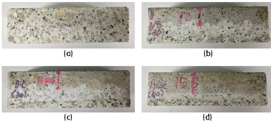
30분간 금속 나노입자의 침투; (a) 도포하지 않은 석재, (b) No bias, (c) DC bias, (d) Pulse DC bias
