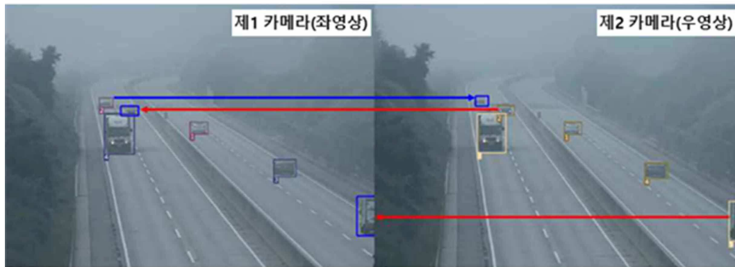
(b) 안개 발생시의 스테레오 영상과 딥러닝을 이용한 차량 추정 결과와 좌영상과 우영상 간의 부등각사상변환 파라미터를 적용한 탐지
