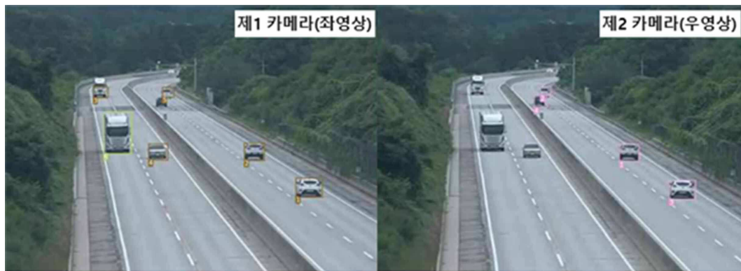
(a) 정상시의 스테레오 영상과 딥러닝을 이용한 차량 추정
