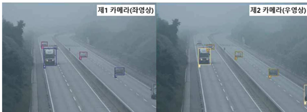
(b) 안개 발생시의 스테레오 영상과 딥러닝을 이용한 차량 추정
